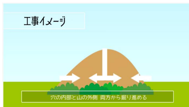
第一豎坑と豎坑方式による工事の順序図（動画の解説）
