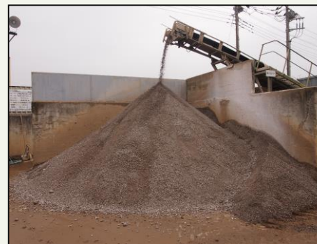
石灰改良土は、水分が少なく強度の高い土ですので、施工後の地盤沈下や液状化の防止対策に効果的な優れた建設資材となります
