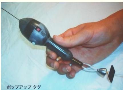
これをウナギの背中に付けて放すと、センサーが水深や水温、照度などのデータを集めてくれます。タグがウナギから切り離されて海面に浮上すると、人工衛星経由でデータが地上局に送られてきます。そのデータを解析した結果、夜は水深 200m、昼は 800m 前後の層にいて、規則的な日周鉛直運動をすることが分かりました。
