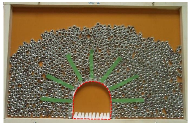
写真-3 鉄の棒がある場合のトンネル実験 (掘削後)
