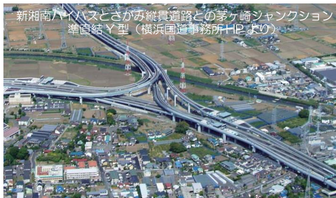
インターチェンジ・ジャンクションの代表的な型式 (道路構造令の解説と運用より)
