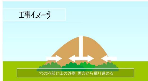
まず山の上から穴を掘り下げ、穴の内部と山の両側の両方から同時に横穴を掘り進め、トンネルを開通させます。こうしてできた地上の坑が、この「第一豎坑」なのです。この方法は「豎坑方式」と言われ、この工事が、日本で最初の工事だそうです。前例がなく多々の工夫を要し、さらに固い岩盤と大量の湧き水で工事は難航。時には排水ポンプが浸水で故障し、約2か月間、工事がストップしたそうです。
