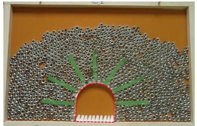
写真-3 鉄の棒がある場合のトンネル実験
