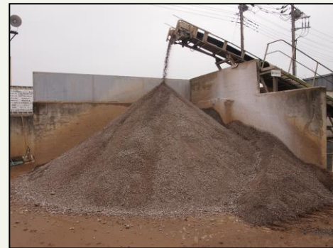
石灰改良土は、水分が少なく強度の高い土ですので、施工後の地盤沈下や液状化の防止対策に効果的な優れた建設資材となります
