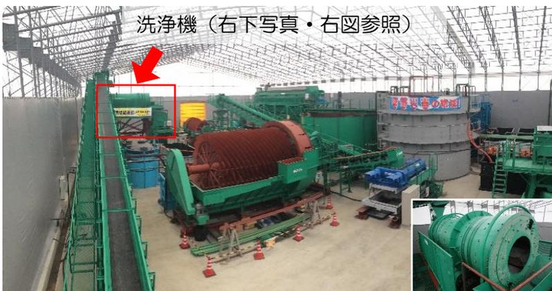
洗浄機（右下写真・右図参照）
