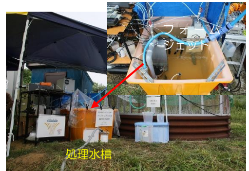
写真-3 1,4-ジオキサン処理実験
