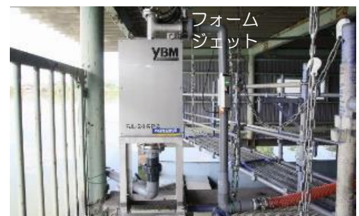
写真-6 湖沼での酸素UFB発生装置
