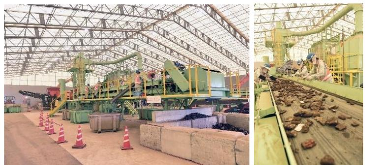
写真-2 解体残渣の選別設備全景(左)と手選別状況(右)
